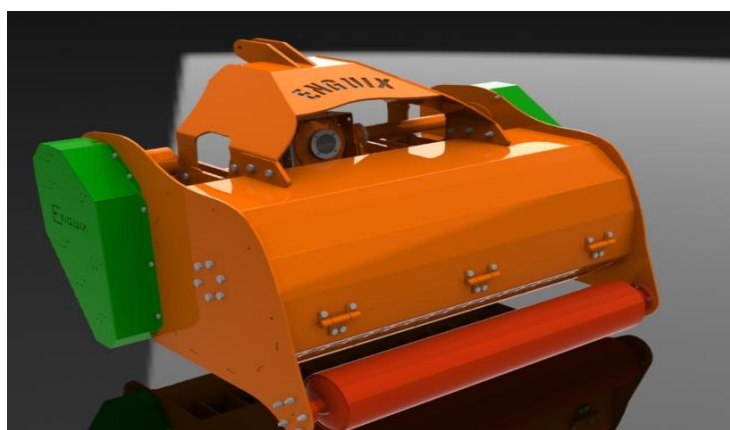
Vedere din spate, sistem de tavalug stabilizator.
